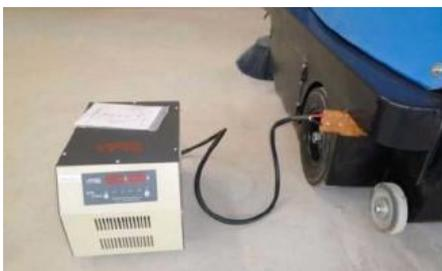
Зарядное гнездо расположено на правой задней стороне корпуса. В конце работы просто подключите разъем зарядного устройства к зарядному гнезду подметальной машины, как показано на рисунке.
